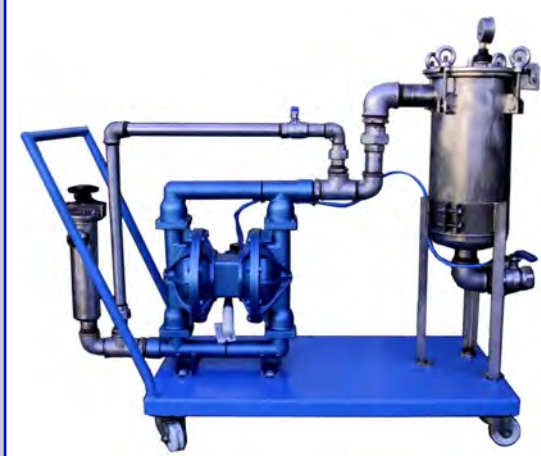
Equipo de trasiego con pre-filtro, bomba de membranas y filtro de bolsa
