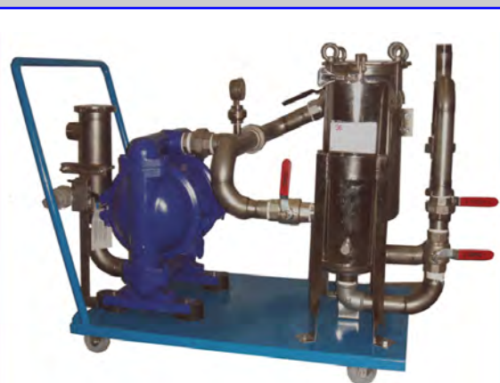
Equipo de trasiego con bomba de membranas que impulsa a filtro de bolsa o a carcasa de acero inoxidable con 3 filtros cunco de 10"
