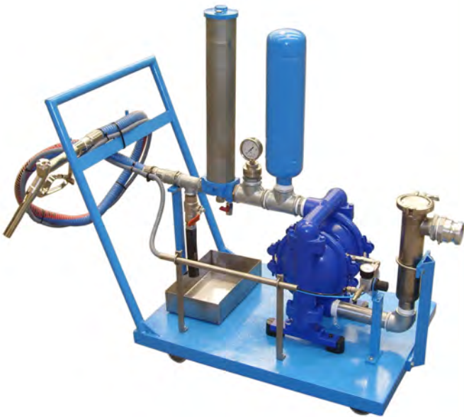
Equipo de trasiego con bomba de membranas, pre-filtro amortiguador de vibraciones, filtro cunco de 20", pre-filtro de 1 1/2" y pistola dosificadora
