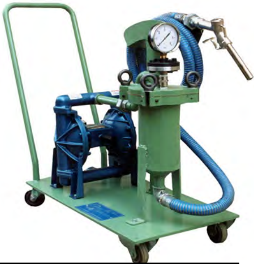
Equipo dosificador con bomba neumática y filtro de bolsa
