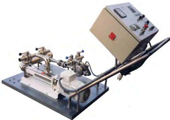
Equipo dosificador con bomba tipo mono con contador de ruedas ovaladas y programador
